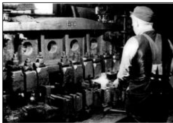
Fig. 68. Ovan visar det första momentet i yxtillverkning på Kölefors bruk. I en s.k. smidpress pressades yxämnet efter önskad modell. Pressen hade en tryckkraft på 170 ton. I maskinen satt olika pressverktyg fastskruvade beroende på vilken modell som skulle tillverkas. 104
