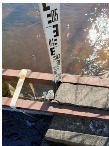
Figur 11. Fixpunktens placering som har nivån +100,12 m i höjdsystem RH2000 vid Kölefors Övre.
