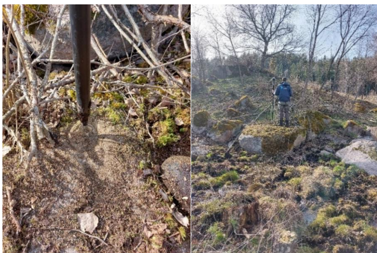
Figur 5. Fixpunktens placering som har nivån +10,00 m i det lokala höjdsystemet vid Kölefors Vaddfabrik. Dammbeskrivning.
