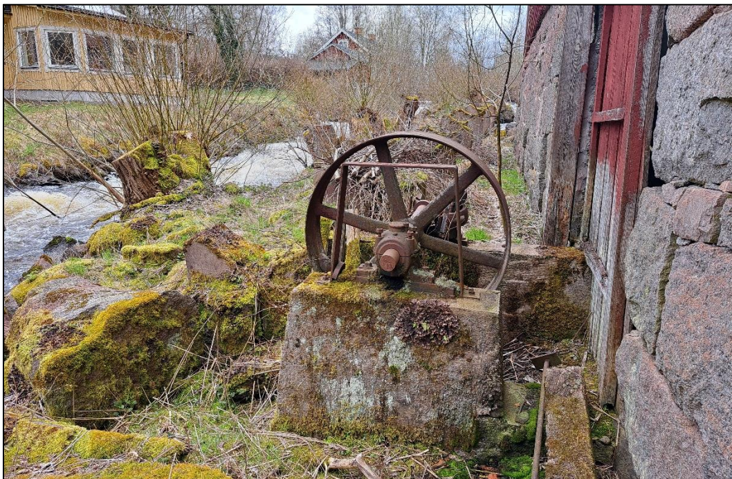
Fig. 42. Maskineri för remdrift, kopplat till turbinen. I kvarngrunden t.h. finns en öppning in i kvarnen. Foto taget mot söder.
